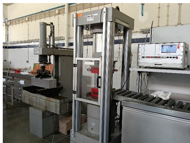
Figura 1 - Máquina de ensaio de flexão e compressão do betão.
