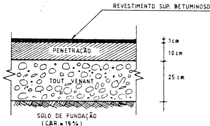
Fig.11 - Perfil-tipo dum pavimento flexível equivalente ao rígido executado
