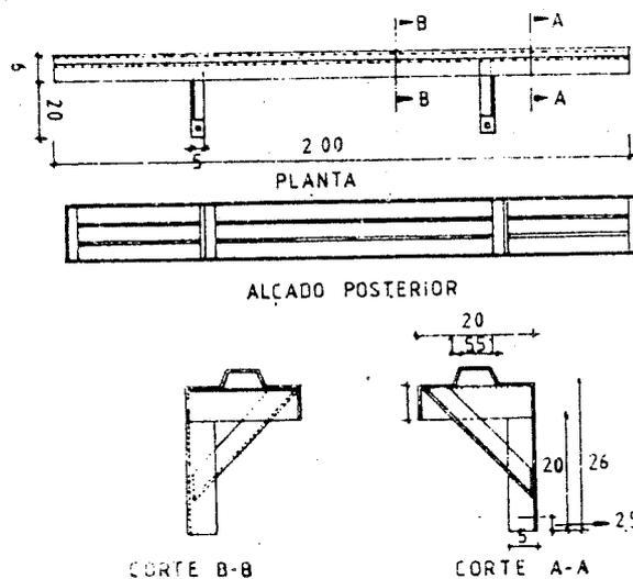
Fig.8 - Elemento da cofragem de ferro utilizado na pavimentação do Pisão.
