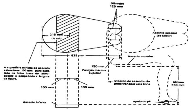
O tracejado pode ser sobreposto como está indicado, desde que sejam instalados apoios para os pés e haja suficiente espaço para as pernas e a separação vertical entre os assentos superiores e inferiores seja, num mínimo, de 350 mm.
