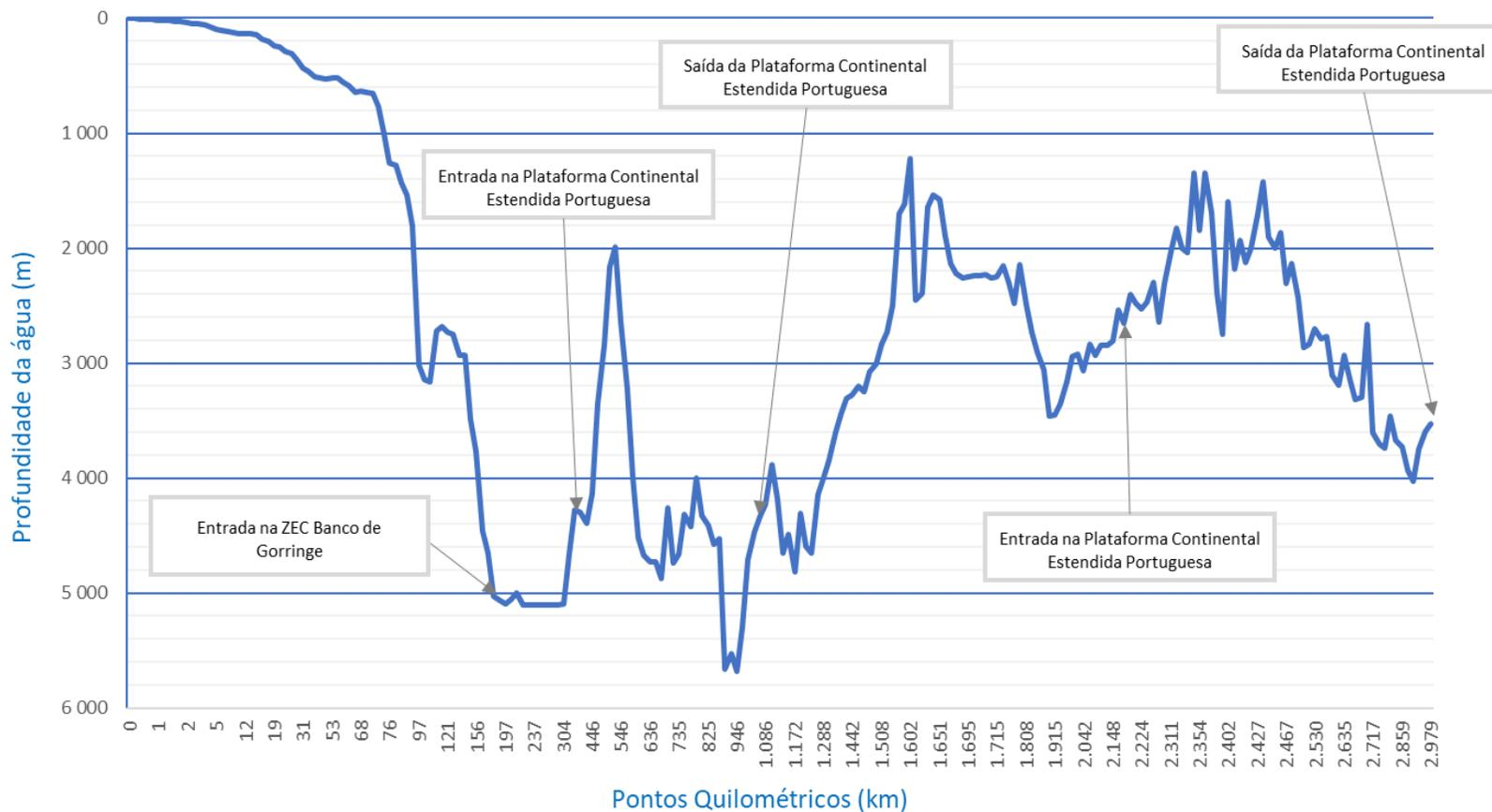
Figura 7.1 – Profundidade da água para instalação do cabo NUVEM
