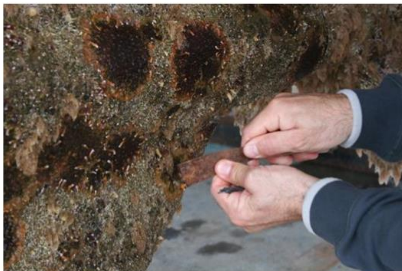
Figura 11. Raspagem do casco de uma embarcação em doca seca.
