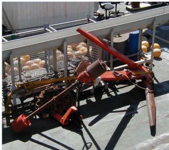
Figura 3.5 – Fotografia da ferramenta de remoção dos cabos OOS (Fonte: SubCom 2024)
