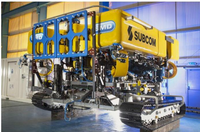
Figura 3.2 – Exemplo de um veículo operado remotamente (ROV) (Fonte: SubCom, 2024)
