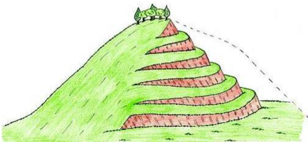
Figura 2.3 | Esquema da intervenção projetada para a Saibreira do Cabeço dos Trupes – estabilização em patamares (Caetano, 2007)
