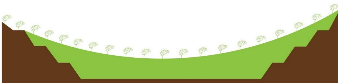
Figura 2.3 | Esquema da intervenção projetada para a Pedreira de Santa Luzia – enchimento parcial
