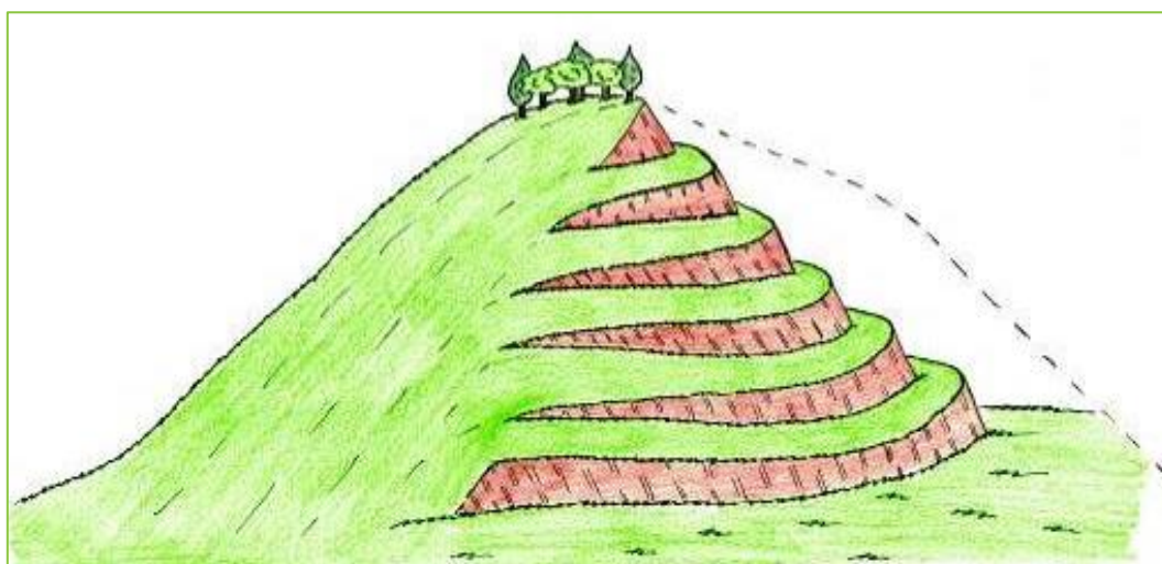
Figura 2.3 | Esquema da intervenção projetada para a exploração das Areias do Salto da Moça – estabilização em patamares (Caetano, 2007)
