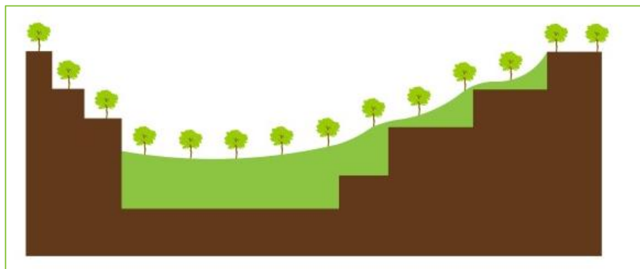
Figura 2.3 | Esquema da intervenção projetada para a recuperação da Pedreira do Areeiro – enchimento parcial (adaptado de Bastos & Azevedo e Silva, 2005)
