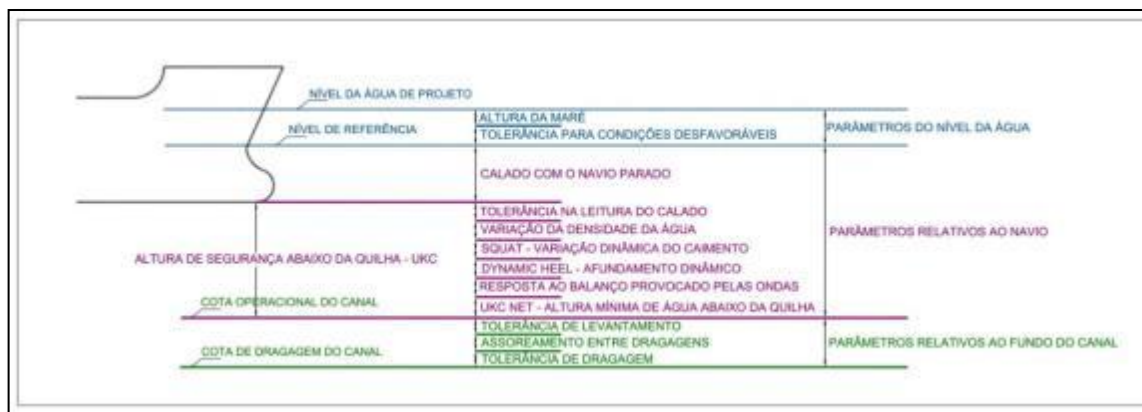
Fig. 10 – Indicação dos principais parâmetros a ter em conta na determinação das dimensões verticais submersas (PIANC, 2014)
