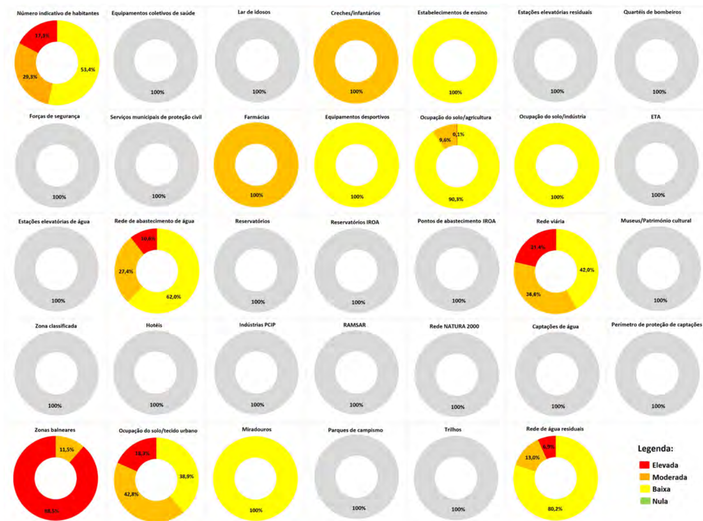
Figura 5.26 | Representação gráfica da proporção dos edifícios/elementos vulneráveis por categorias de suscetibilidade a inundações/galgamentos para a frente marítima de São Roque (ilha de São Miguel) (são representados a cinzento os elementos/edifícios vulneráveis onde não existem na bacia hidrográfica).
