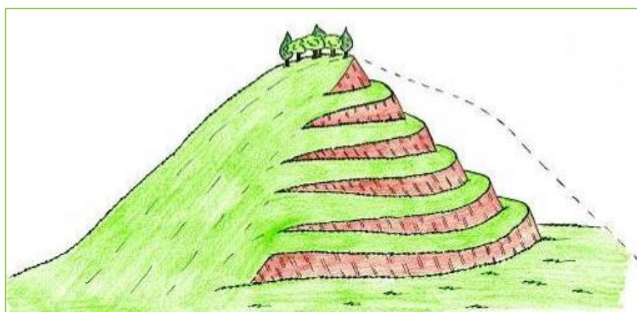
Figura 2.3 | Esquema da estabilização em patamares em cones de escórias nos Açores (Caetano, 2007)
